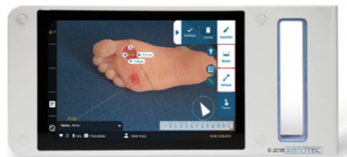
Exakte Wundvermessung und Bildvermaßung über einen hochmodernen ToF-Sensor
